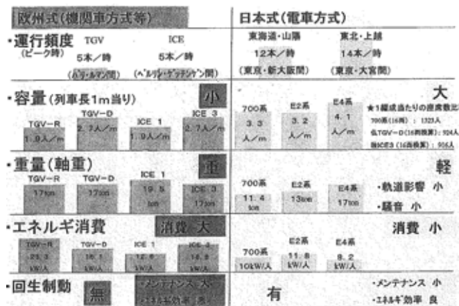
図2 日本方式と欧州の動力集中方式との比較
